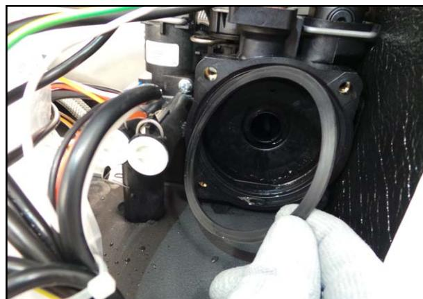
N.B. Ricordarsi di rimontare anche la guarnizione.
